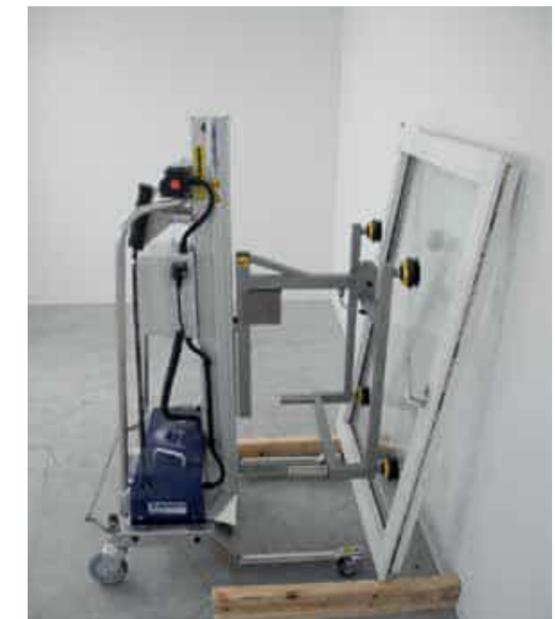
MobilLift mit Vakuumtechnik
