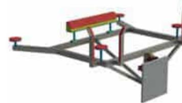
Ausleger mit drehbarer Traverse
