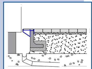
Sockelbelüftung gesichert, Abfluss möglich durch Sobekon®
