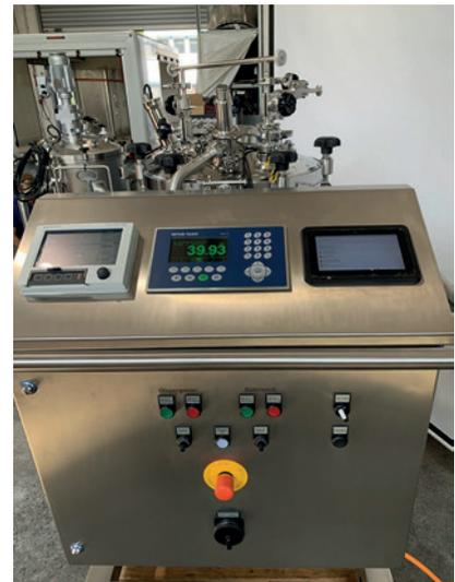
Abbildung 2: Steuerungs- und Übertragungseinheit.
