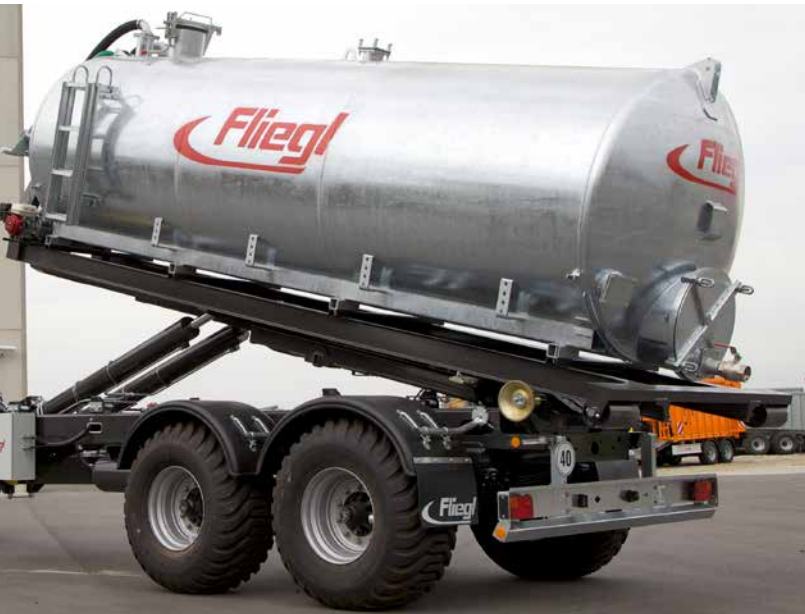
Fassaufbau als Abroller
