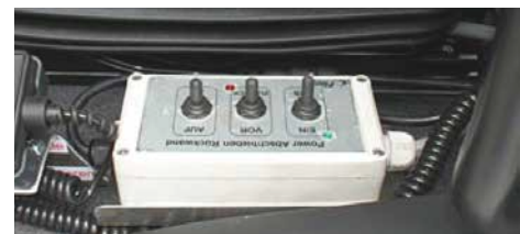
Hydraulische Ansteuerung über Bedienpult (optional)
