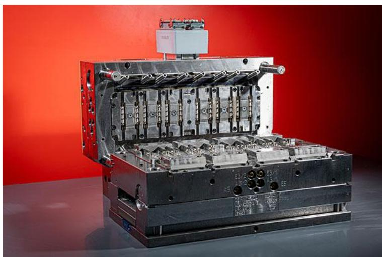
Zinkdruckguss-Heißkanalwerkzeug: Die Heißkanaltechnologie im Zinkdruckguss verbessert die Guss- und damit die Bauteilqualität. Diese höhere Qualität reduziert die Ausschusskosten in der nachfolgenden Oberflächenbehandlung und ermöglicht insgesamt eine wirtschaftlichere Fertigung durch geringere Herstellkosten.
