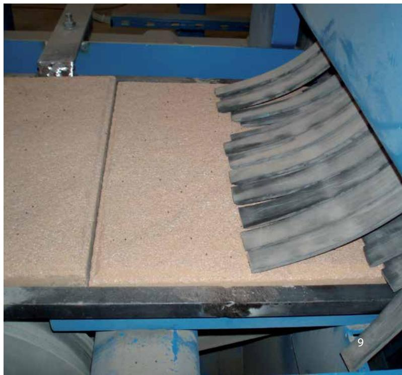
**Drahtgurt-Strahlanlagen** werden für die Bearbeitung unterschiedlichster Werkstücke eingesetzt. Ihr Vorteil ist, dass die Teile von zwei Seiten gleichzeitig gestrahlt werden.
