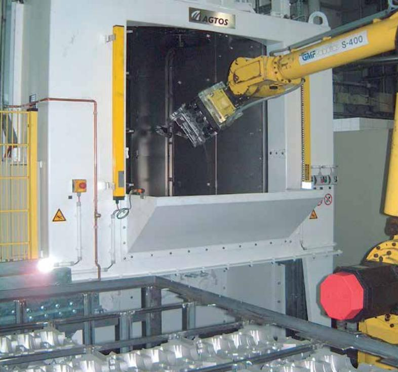
**Drehtisch-Strahlanlagen** werden in unterschiedlichen Größen und Versionen gebaut. In der Automobilindustrie werden zum Verfestigen gern auch Satelliten-Drehtisch-Strahlanlagen eingesetzt. Hohe Taktung und zuverlässige Strahlergebnisse sind das Ergebnis. Zudem ermöglichen sie die Automatisierung des Prozesses.
