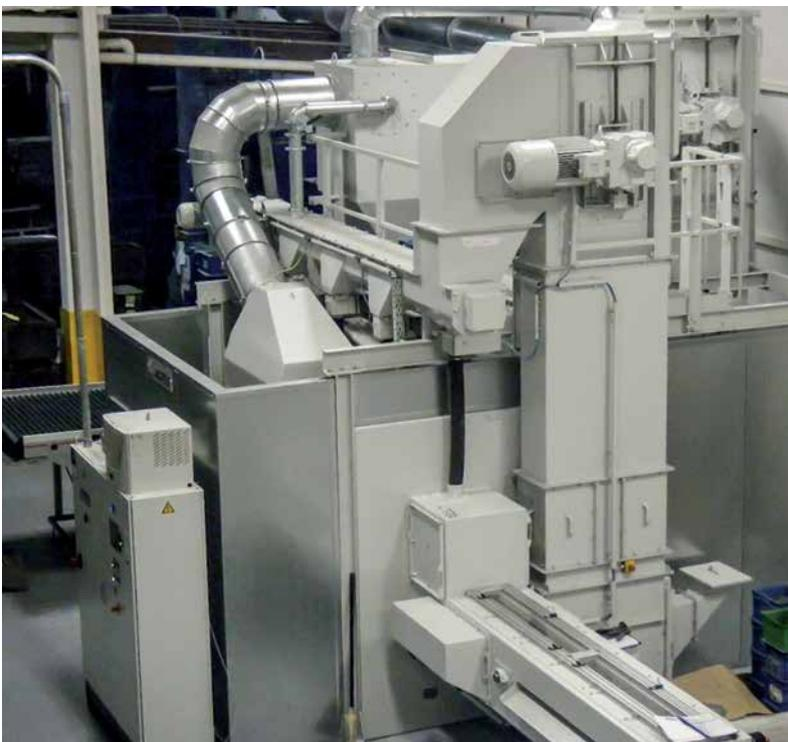
**Walzen-Strahlanlagen** sind für den schonenden Transport von Werkstücken aller Art ausgelegt. In diesem Fall sind es Federn, die verfestigt werden.
