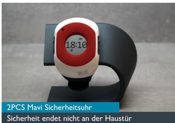
Nach jeder Rufauslösung erfolgt eine einmalige automatische Ermittlung des Standortes, der mit dem Ruf angezeigt und mit der Rufnachricht übertragen wird. Die Ortungsfunktion ist im laufenden Betrieb je Nutzer deaktivierbar. Bei Bedarf können manuell zusätzliche Standorte abgefragt werden.
