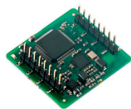
TWN4 MultiTech HF Mini Full version: 13.56 MHz, NFC
