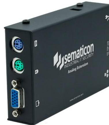
Die **se.MIS™ KVM-Analog-Duo-Erweiterung** bietet gegenüber der Analog-Variante den Vorteil, dass noch ein lokaler Bildschirm oder ein lokales HMI-Panel verbunden werden kann. Der Steuerungs-PC wird mit dem Eingang verbunden und der lokale Bildschirm mit dem Ausgang.
