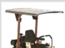
**SONNENSCHUTZDACH** – Aus diamantbeschichtetem Aluminium oder strapazierfähigem Vinyl zur Begrenzung der direkten Sonneneinstrahlung und Hitzeeinwirkung, zur Reduzierung der Augenbelastung und zur Erhöhung des Bedienkomforts bei gleichzeitig großer Kopffreiheit.
