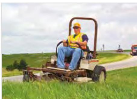
Das einzigartige vierspindlige Design des optionalen 4X Rear Discharge™ DuraMax®-Decks verteilt die Lasten des Schnittgutes gleichmäßig und eliminiert das Schwaden, während das Material nach hinten und weg vom Fahrer und Motor geleitet wird. Es ist möglich zu mähen mit beiden Seiten des Decks - im Gegensatz zum Handrasenmäher - für reduzierte Kosten.
