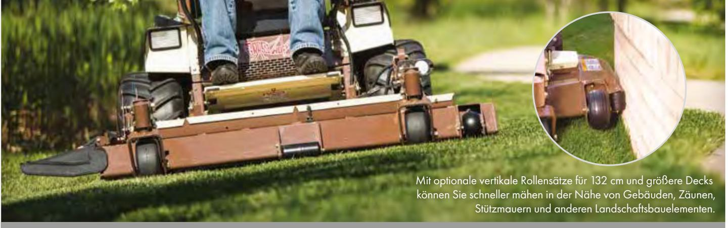
Mit optionale vertikale Rollensätze für 132 cm und größere Decks können Sie schneller mähen in der Nähe von Gebäuden, Zäunen, Stützmauern und anderen Landschaftsbauerelementen.
