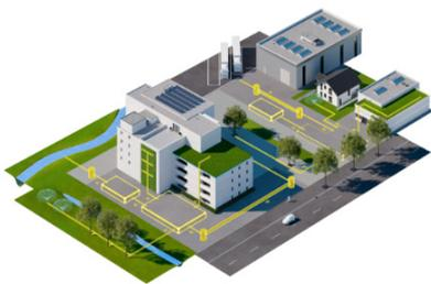
Zisternen spielen in der Schwammstadt eine tragende Rolle: Sie machen das gesammelte Regenwasser für Bewässerungszwecke und nichttrinkbare Anwendungen wiederverwendbar und reduzieren die ungenutzte Ableitung.
