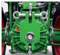
agria-Anbauflansch: einfacher und schneller Anbaugerätewechsel
