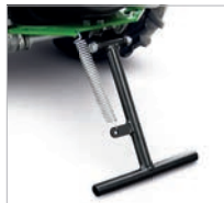
Stützfuß erleichtert das Abstellen der Maschine
