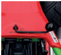
Sicheres Abstellen der Maschine mit zentraler Feststellbremse
