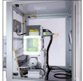
Vorteile sind schnelle Schweißgeschwindigkeiten, hohe Präzision und geringe Verformung. Es wird in der Automobil-, Medizin- und Elektronikindustrie eingesetzt. Wir bieten Unterstützung bei Materialwahl, Bauteildesign, Spritzguss, Laserschweißen, Laserkennzeichnung sowie Service und Inbetriebnahme.
