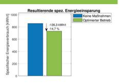
Die Kombination aus verbesserten Beschickungsintervallen und Materialvorwärmung bewirkt eine Reduktion des spezifischen Energieverbrauchs um ca. 15 %. Beide Maßnahmen ergänzen sich demnach hinsichtlich der erzielbaren Einsparung. Innerhalb eines Jahres führt dies zu einer Energieeinsparung von 1,7 GWh, was einer Gaskosten-Ersparnis von ca. 45000 € entspricht.
