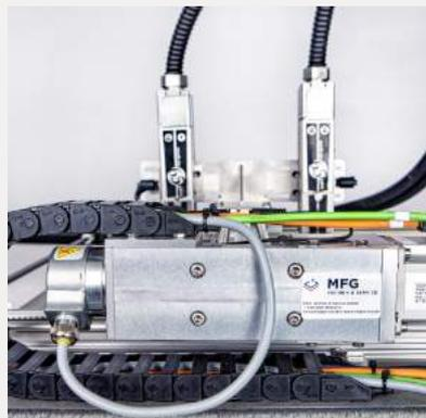
**Einbindung Drucker:** Teil der MFG Verfahrachsen ist die Einbindung von MFG Drucktechnologie – insbesondere von Hitachi Inkjet Systemen, Hi-Res-Tinten-drucksystemen oder auch Lasertechnik.
