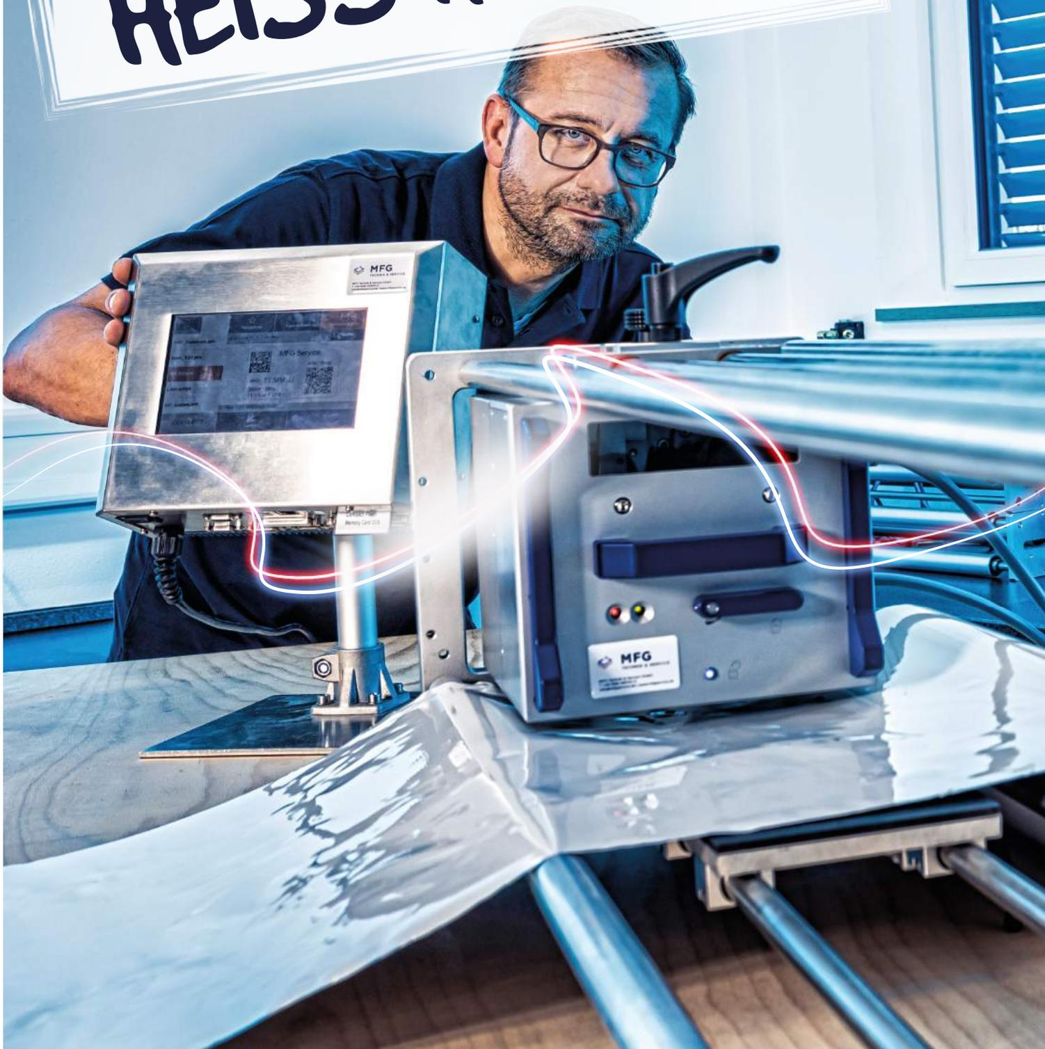
Das Thermotransfer-Verfahren wird überall dort eingesetzt, wo ein hohes Maß an Flexibilität im Druckbild gefordert ist, z. B. bei der Kennzeichnung von Folienverpackungen und Etiketten. Fast alle Verpackungsfolien, die auf vertikalen und horizontalen Folienverpackungsmaschinen verarbeitet werden können, lassen sich problemlos bedrucken.
