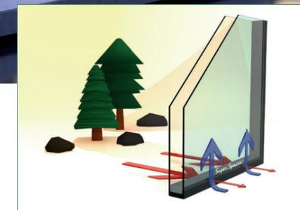
Im Sommer minimiert Super Spacer® den Wärmeaustausch an den Rändern der Glasscheiben und hält die kühle Luft im Haus.
