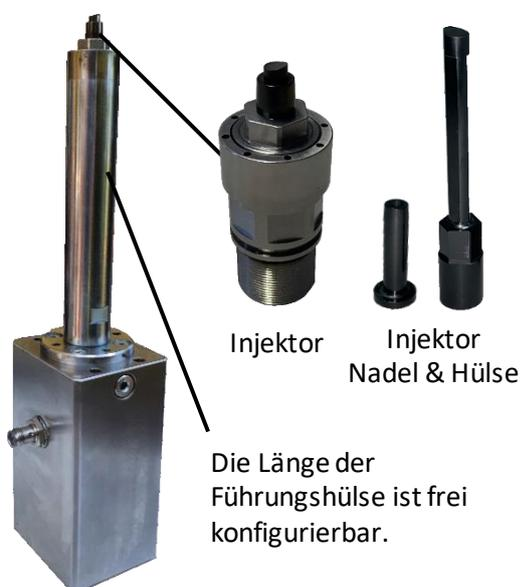
Der Injektor durchsticht die erstarrte Randschicht und leitet das Prozessgas, zur Verdrängung der flüssigen Schmelze im inneren des Bauteils, in die Nebenkavität.
