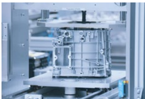
HA-P: Induktives Erwärmen und Fügen der Lagerbuchse von unten
