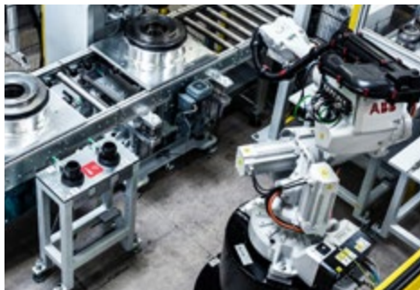
bei Temperaturunterschied >2^{\circ}\text{C} zwischen Werkstück & Lager: Positionierung des Lagers auf n.i.O.-Ablage
