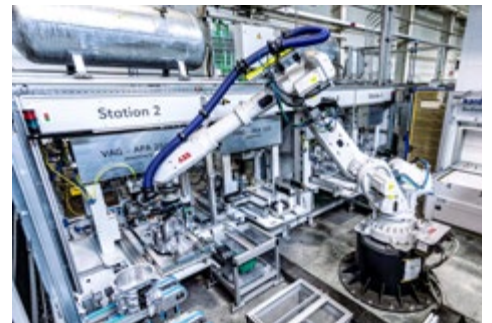
Dichtheitsprüfung der fertig montierten Bauteile
