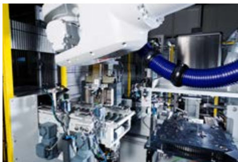
Übernahme des Zylinderkopfes vom Einlaufrollengang
