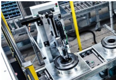
Überprüfung der Durchmesser in verschiedenen Bohrungstiefen
