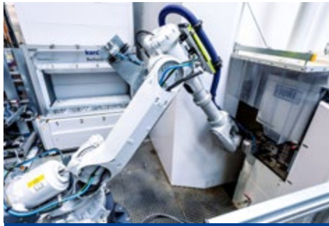
Entnahme des Bauteils aus der Waschzelle
