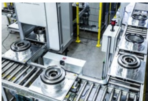
Ist die Kraft-/Weg-Kurve n.i.O.: Transport zu n.i.O.-Stopper, es erfolgt keine Laserkennzeichnung
