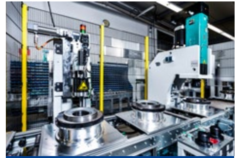
Einlauf in Messstation mit DMC-Leser und DIATEST-Messsystem
