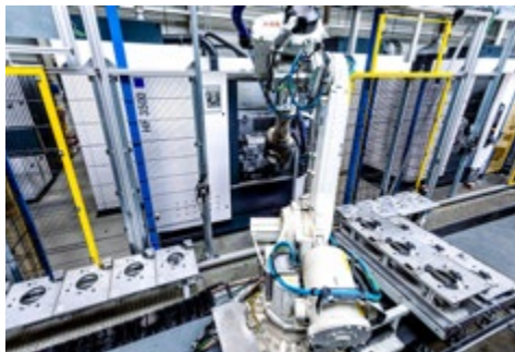
Je nach Bauteiltyp verschiedene Bearbeitungen in 15 Bearbeitungszentren
