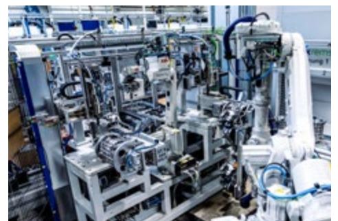
Beladung für Montage der Blechdeckel
