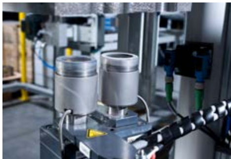
Einpressen von stickstoffgeköhlten Ventilsitzringen
