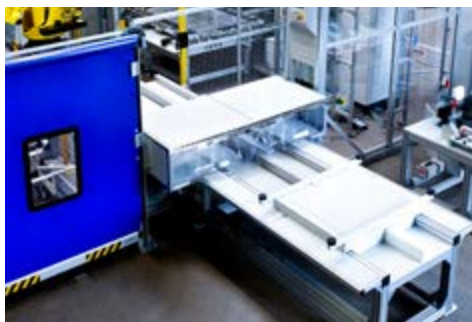
Ausschleusung von n.i.O.-Teilen via Shuttle
