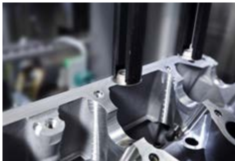
Montage Federteller unten
