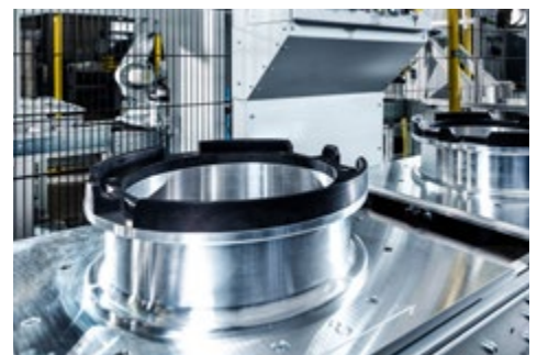
Qualität des DMC i.O.: Transport des montierten Werkstücks zu Entnahmestopper
