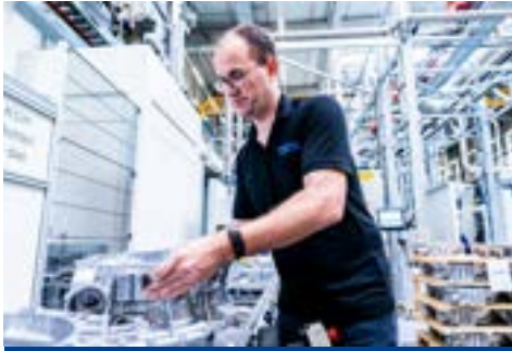
Manuelle Rohteileinschleusung über Umlaufband
