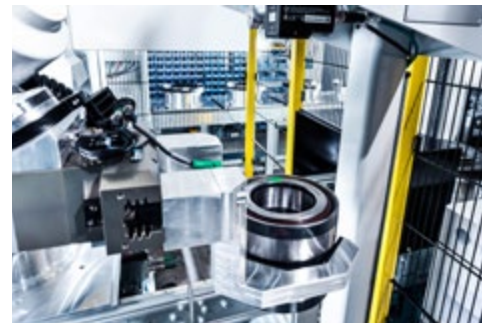
Entnahme der Lager via Roboter sowie automatische DMC-Lesung bei jedem Einbauteil
