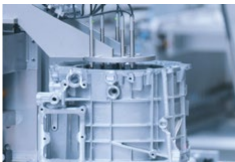
HA-P: Maßliche Kontrolle der Fügeposition, anschließend Übergabe zur weiteren Bearbeitung
