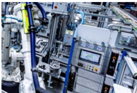
VA: Fügen der Lagerbuchse inkl. Positions- und Temperaturüberwachung
