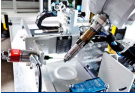
Loctite-Benetzung der Injektorhülsen
