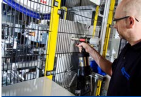
Montage der KVT-Expander-Stopfen
