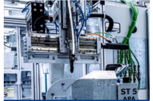
Positionieren und Verschrauben der Blechdeckel
