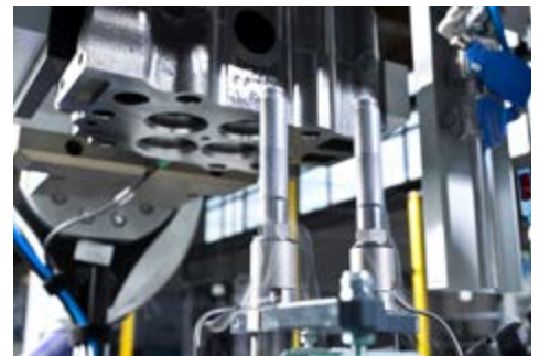
Einpressen von stickstoffgeköhlten Ventilfehrungen
