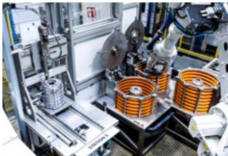
Entnahme eines Bauteils (Vorderachse-VA) aus Vorreinigung
