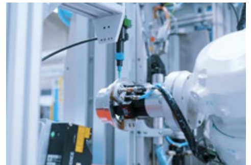
VA: Automatischer Dichtmittelauftrag inkl. Kontrolle mittels 3D-Scanner
