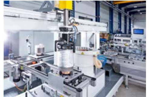
anschließender Fügeprozess mit Kraft-/Wegüberwachung
