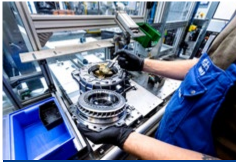
HA: Manuelle Vormontage der Kühlkörper, anschließend automatische Montage
