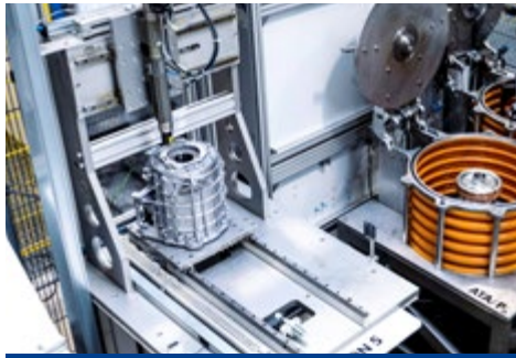
HA: Verschraubung des Kühlkörpers mit Parameter-Überwachung
