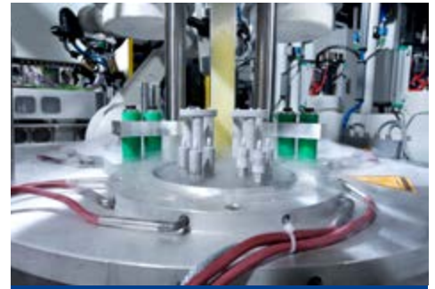
Automatische Bestückung des Flüssigstickstoffbehälters mit Ventilsitzringen und Ventilfehrungen
