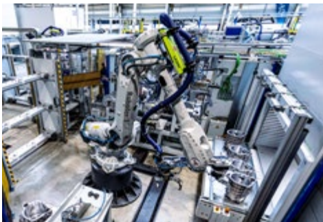
Ablage in Regalsystem zum Aushärten des Dichtmittels sowie zur Übergabe an Zelle 6
