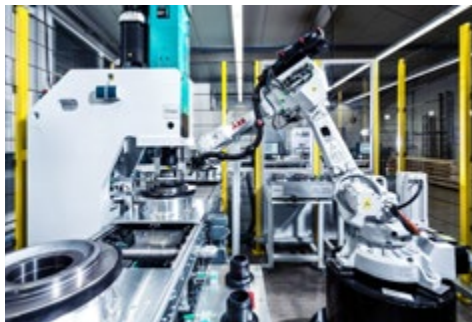
Positionierung des Lagers zur Temperaturmessung
