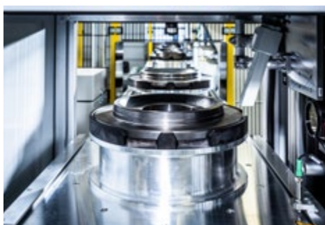
Kurve i.O.: Transport in Laserkabine, DMC-Auslesung sowie Laserkennzeichnung mit gesammelten Daten
