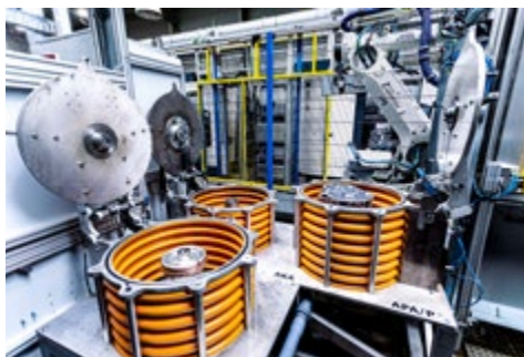
Vorreinigung der mit Kühlmittel verschmutzten Teile (Hinterachse-HA)
