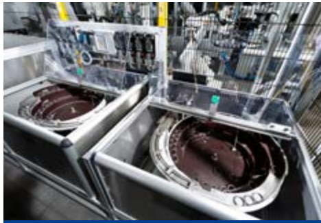
Automatische Zuführung von Ventilsitzringen
