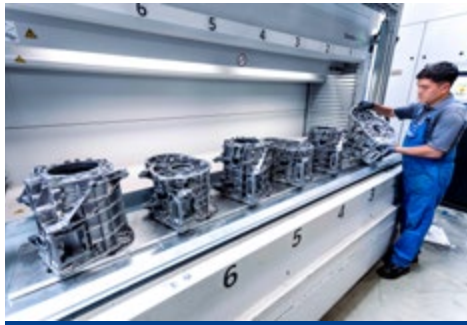
Einschleusung inkl. Pufferspeicherung über modularen Vertikallift
