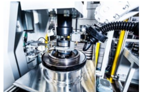
bei Temperaturunterschied <2^{\circ}\text{C} : Einpressvorgang mit bis zu 150 kN
