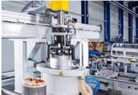
induktive Erwärmung des Gehäuses
