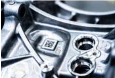
Ergebnis der Laserbeschriftung
