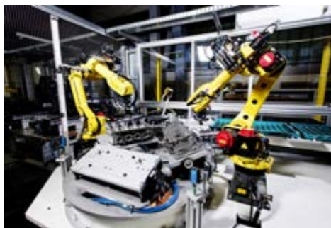
Montage HVA-Elemente und Rollenschlepphebel
