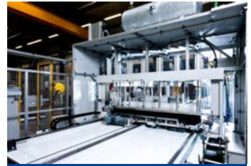
Dichtheitsprüfung mit Luft und kleinen Prüfdrücken
