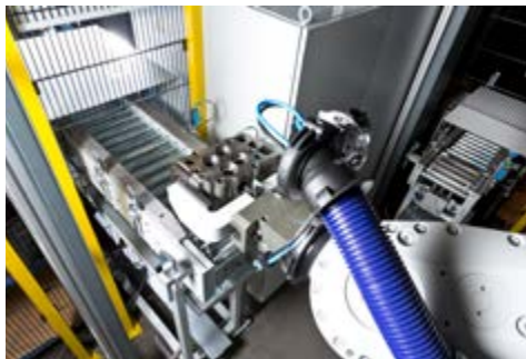
Übernahme des Zylinderkopfes vom Einlaufrollengang
