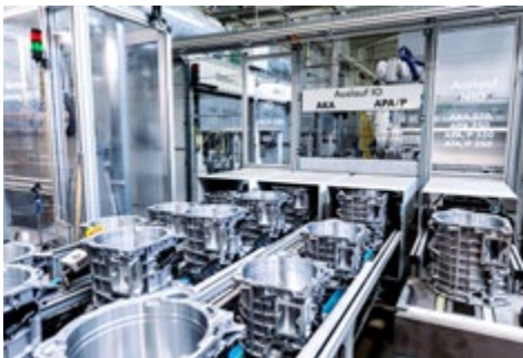
Ausschleusung der geprüften Bauteile
