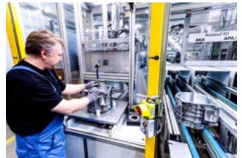
Handarbeitsstation zur Blechringmontage (Hinterachse, Typ Performance)
