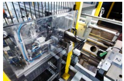
Vollautomatische O-Ring Montage
