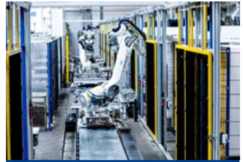
3 Roboter auf einer Achse für intelligentes Bauteilhandling
