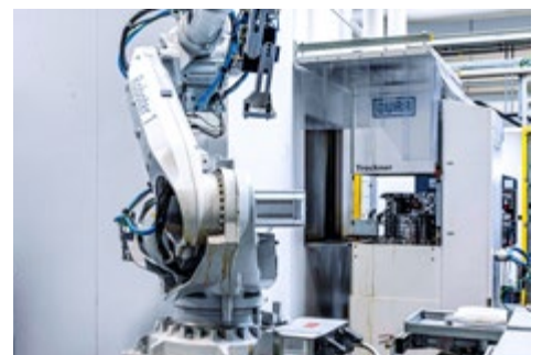
Nach Bearbeitung: Übergabe Bauteil zu Zelle 3 für Reinigung und Trocknung
