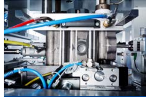
Dichtheitsprüfung Öl-Raum mittels Druckdifferenzverfahren
