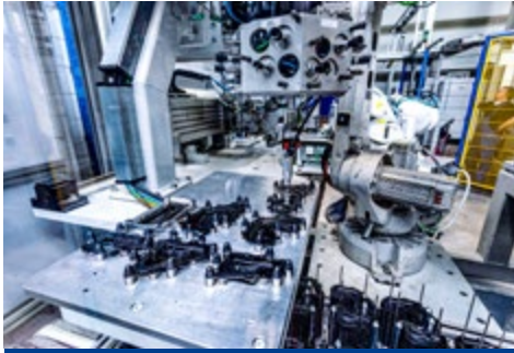
Automatisierte Entnahme der Blechdeckel
