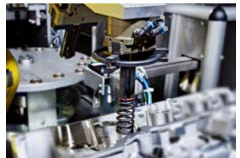
Feder- und Federtellermontage
