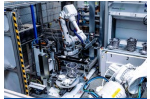
Automatische Verschlussstopfenmontage & Eindrehen von Verschlusschrauben
