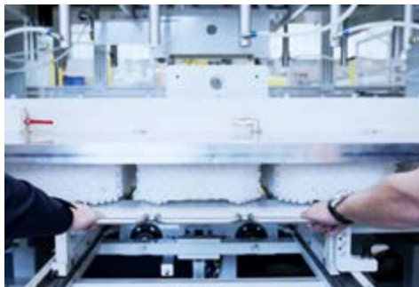
integrierter Sonderablauf zum Wechsel der oberen Dichtplatte
