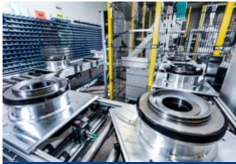
Einschleusung über Stopper-Vereinzeler
