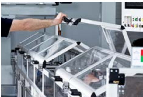
Ausschleusung n.i.O.-Teile mit Entnahmemöglichkeit nach Abkühlzeit
