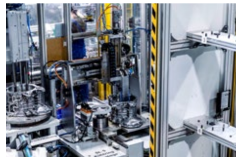
Automatische Montage Kühlring
