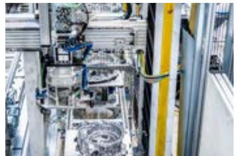
Übersetzer zum Kapazitätsausgleich zwischen den Linien
