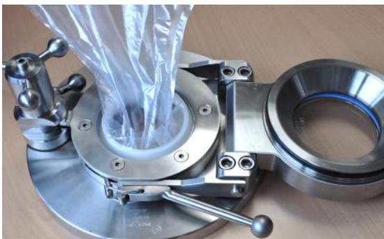
Schnellspannvorrichtung für Beutel mit TriClamp-Stutzen
