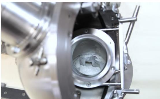
Blick in das Abwurfrohr mit 100 % freiem Querschnitt
