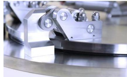
Kniehebelmechanik verriegelt den Verschluss eigensicher. Durch gesicherte Spaltbildung beim Öffnen wird der Druckbehälter gefahrlos entlastet.
