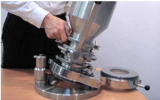
Stoffeintrag aus Kleinbehälter, mit zusätzlicher Klappe
