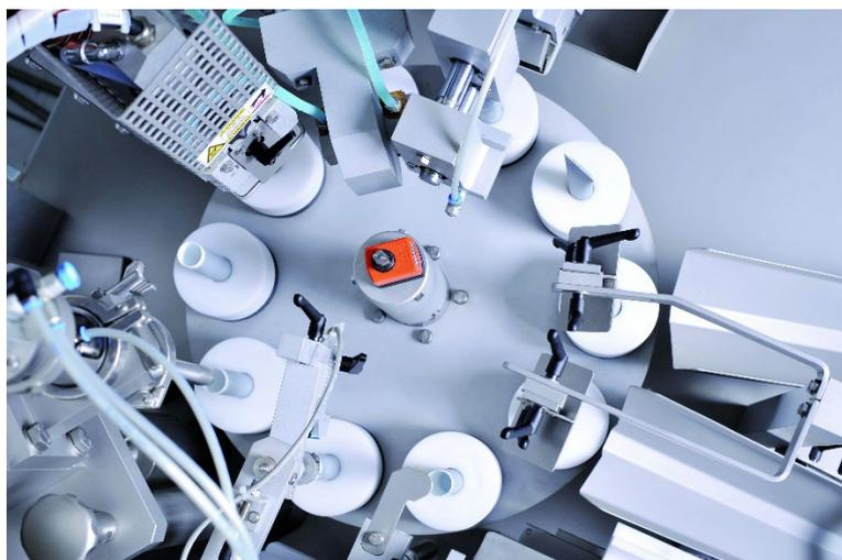
Tubentransportsystem des IWK Tubenfüllers FP 10.
