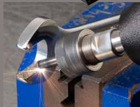
Wolframcarbid-Hartmetallbeschichtung auf beanspruchten Flächen mit dem ENESKA rapidcoat
