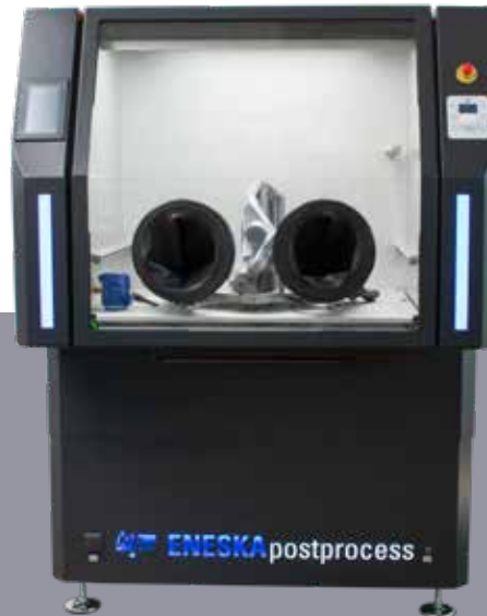
2021: joke stellt das innovative Nachbearbeitungszentrum ENESKApostprocess vor: Komplette Einhausung, Absaugung und Filtertechnik schützen vor Gesundheits- und Explosionsrisiken. Im Bild die erweiterte Version 2024/25 mit neuen Features.
