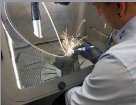
Geschützte Bearbeitung von 3D-Rohlingen. Gefährliche Stäube und Späne selbst von Titan-Legierungen werden abgesaugt und neutralisiert.
