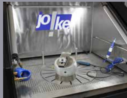
Anschlussmöglichkeiten für alle Mikromotoren, Handstücke, Feilmaschinen der ENESKAmicro Baureihen an die integrierte Gerätesteuerung und praxisgerechte Spann- und Zuführeinrichtungen
