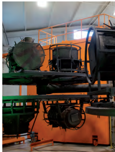
Maschine im Rotations Verfahren
