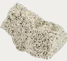
Erfüllt Spezialanforderungen in der Druckfestigkeit. Für Leichtschüttungen mit höchsten Lastanforderungen und dynamischer Krafteinwirkung im Infrastruktur-, Strassenbau und Schienenverkehr. Befahrene Flächen auf Bauwerk oder schlecht tragfähigem Grund. Maximale Standfestigkeit, ausserordentliches Langzeitsetzungsverhalten.
