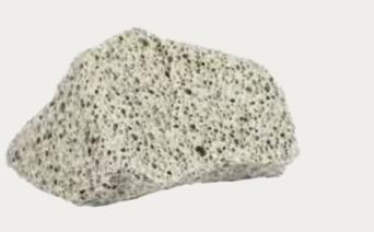
Für Frostgründungen von Wegen und Plätzen oder Aufschüttungen mit einer Schichtstärke von minimal 7.5 cm. Hohe Drainageleistung bei geringem Gewicht. Geeignet zur Sanierung von Gebäudetrümmern oder Isolierungen unter Fussböden.
