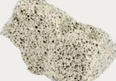
Für Leichtschüttungen mit hohen Lastanforderungen und dynamischer Krafteinwirkung im Infrastruktur-, Strassenbau und Schienenverkehr. Befahrene Flächen auf Bauwerk oder schlecht tragfähigem Grund. Extrem hohe Standfestigkeit, ausserordentliches Langzeitsetzungsverhalten.
