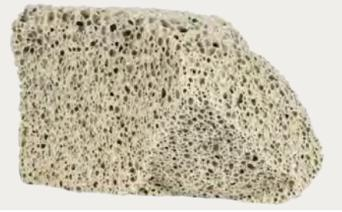
Für Perimeterdämmungen im Hochbau mit hervorragendem Dämmwert sowie geeignet als Leichtschüttung im Garten- und Landschaftsbau. Hohe Standfestigkeit bei geringem Gewicht.
