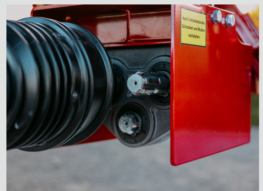
Vorschaltgetriebe zur Drehzahländerung und Drehrichtungsänderung
