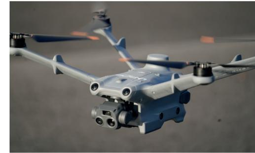
Der Vorteil der Matrice 3TD liegt insbesondere in der 640 Px IR-Kamera, die parallel zu einer Weitwinkel- und Telekamera verbaut ist. Durch dieses 3-Fach Kamerasystem kann die Drohne auch Nachts zur Personendetektion oder in der Inspektion von Industrieanlagen eingesetzt werden.
