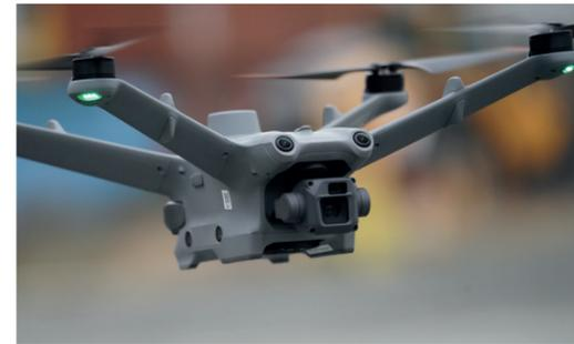
Diese Drohne ist mit einer 20 Mpx Hauptkamera sowie einer 12 Mpx Telekamera ausgestattet. Durch die höhere Auflösung und den großen RGB-Sensor ist die Matrice 3D die perfekte Drohne insbesondere für Vermessungs- und Inspektionsanwendungen.
