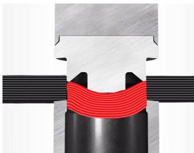
Die Leichtbau-Komponente wird mit ERWin® durch ein nachträgliches Crimpverfahren ohne Vorbohren (oben) oder direkt im Werkzeug bzw. in der Form vorbestückt.
