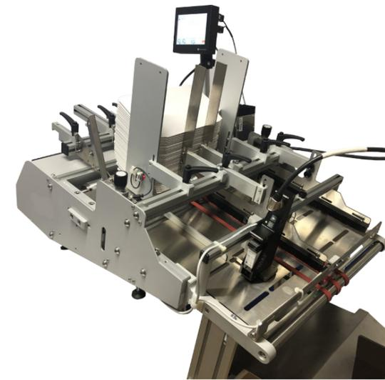
Kompakte Lösung zum Eindrucken von MHD, Lot, Barcode, etc.
