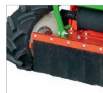
Schutz vor Steinschlag: Wurfkörperprüfung
