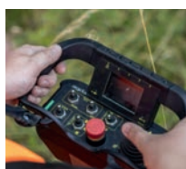
Fernbedienung mit Neigungssensor
