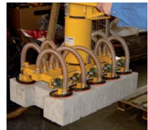
Mehrfachgreifer für die Verlegung von Rinnensteinen
