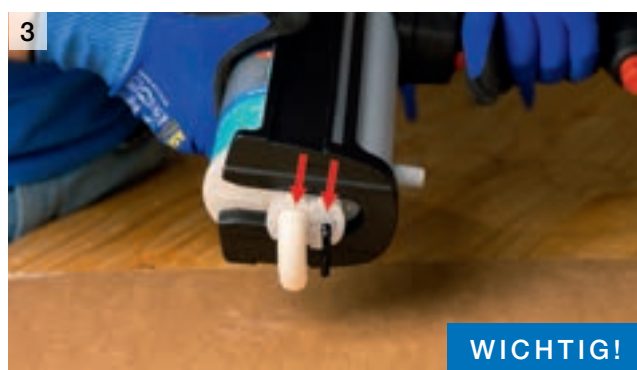
Überwurfmutter abschrauben und Stopfen entfernen
