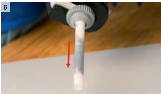
Befüllen des Statikmischer mit Klebstoff. Homogenität der Mischung prüfen (siehe verarbeitungsbegleitende Qualitätskontrollen 2K-Produkte)
