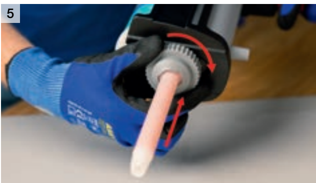
Statikmischer mit der Überwurfmutter fixieren
