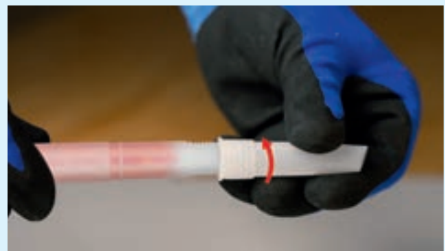
Standardkartuschendüse bis zum Anschlag auf den Statikmischer für BlueLine Kartuschen aufschrauben
