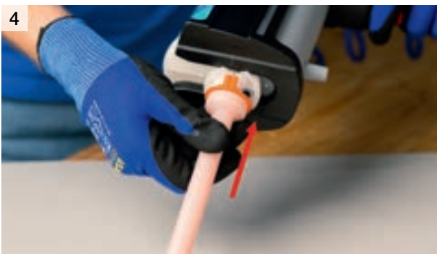
Material abwischen und Statikmischer aufsetzen
