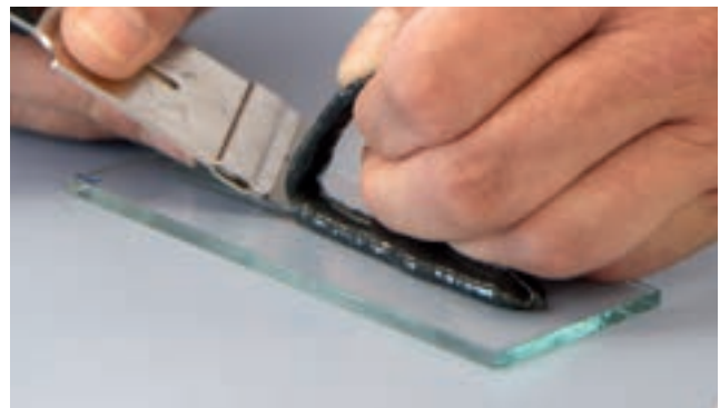
Einschneiden zwischen Klebstoff und Glasscheibe
