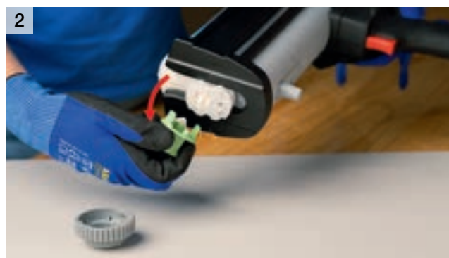
Überwurfmutter abschrauben und Stopfen entfernen
