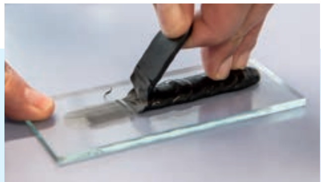
Abziehen der Klebstoffraupe und Beurteilung des Bruchbildes: Wenn es zu einem Kohäsionsbruch im Klebstoff kommt, ist die Haftung zum Substrat einwandfrei
