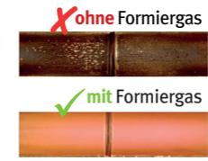
Während des Lötvorgangs wird Stickstoff (N<sub>2</sub>) oder ein Stickstoff-Wasserstoffgemisch (N<sub>2</sub>H<sub>2</sub>) in das Rohrleitungssystem eingeleitet. Durch die Zufuhr von Stickstoff wird der Sauerstoff aus der Umgebungsluft im Rohr verdrängt, wodurch die Bildung von Zunder im Rohr nun nicht mehr möglich ist.
