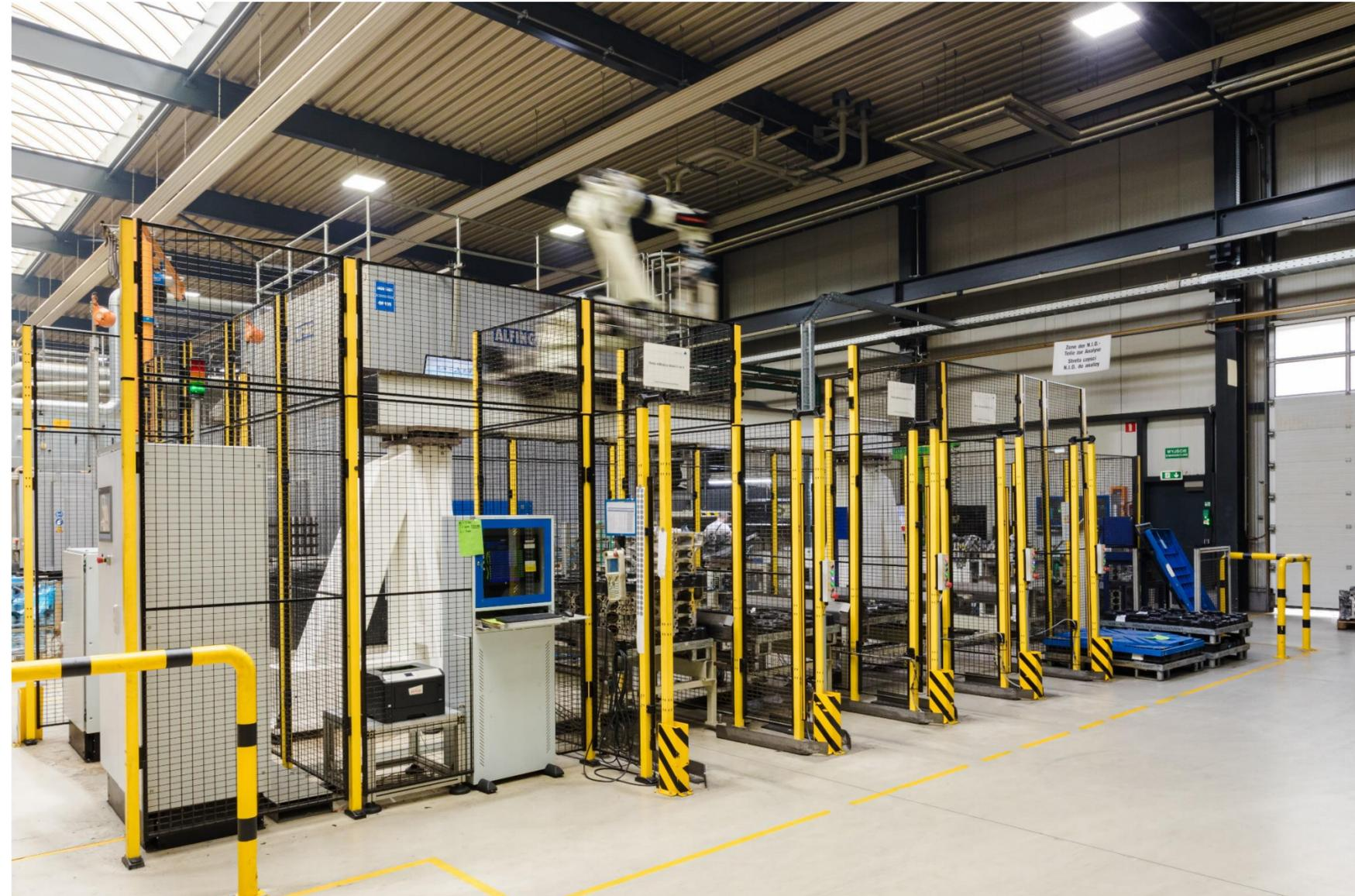
Automatisierte Palettierstation - Motorblock V6/V8
