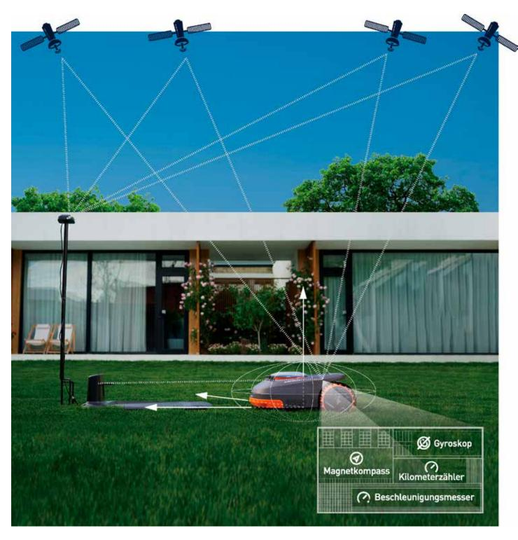
Mit dem Exact Locating System (EFLS) von Segway Navimow kann die virtuelle Begrenzung, basierend auf satellitengestützter Technologie, mit einer Positionierungsgenauigkeit bis auf wenige Zentimeter genau angelegt werden, ohne dass ein Begrenzungskabel erforderlich ist.
