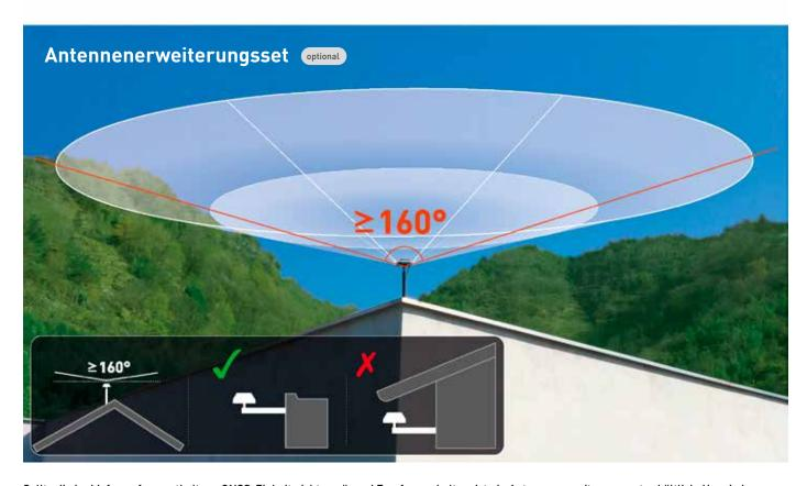
Sollte die im Lieferumfang enthaltene GNSS-Einheit nicht genügend Empfang erhalten, ist ein Antennenerweiterungsset erhältlich. Um ein besseres Signal zu erhalten, installieren Sie die Antenne an einer freien Fläche mit einer ungehinderten Sicht von mindestens 160° auf den Himmel.
