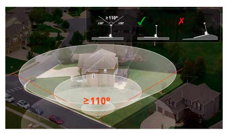
Um ein starkes GNSS-Signal zu gewährleisten, muss die Antenne auf einer offenen Fläche mit einer ungehinderten Sicht von mindestens 110° zum Himmel installiert werden.
