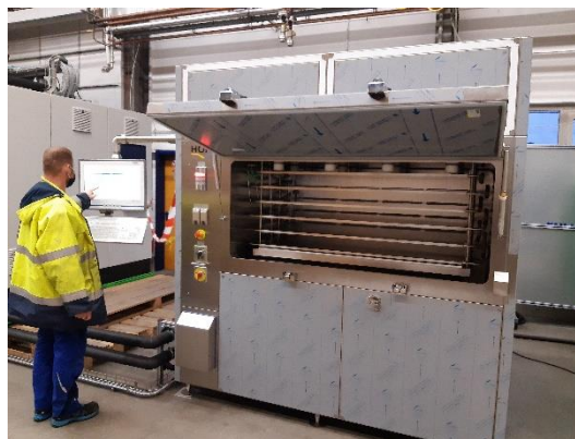
Abbildung 7 HOF Freeze-Thaw-Unit (FTU), Einfriergerät für Beutelsysteme
