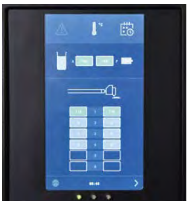
Leicht zu programmierende Bedienoberfläche mit 7" Touchscreen
