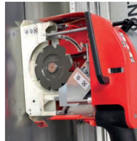
Nutmöglichkeiten für Verbundplatten
