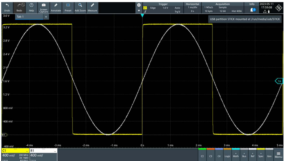
Screenshot: Mit der Referenzfunktion kann ein zuvor gemessenes Signal mit einem aktuellem verglichen werden
