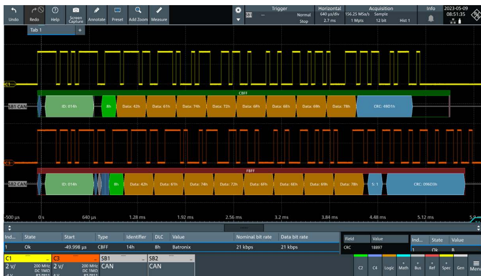
Screenshot: CAN Schnittstellen-Dekodierung und Dekodertabelle
