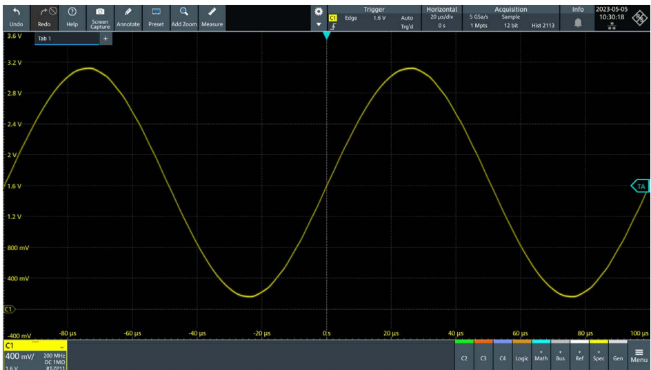
Screenshot: Ein 10-kHz-Sinusignal, passend zum Bildschirm skaliert
