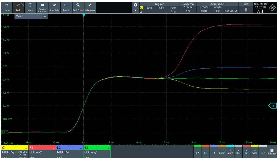
Screenshot: Die Auswirkung korrekter Terminierung bei „elektrisch langen“ Signalen
