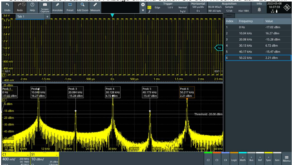
Screenshot: FFT Analyse eines Rechtecksignals mit gut sichtbaren Oberwellen
