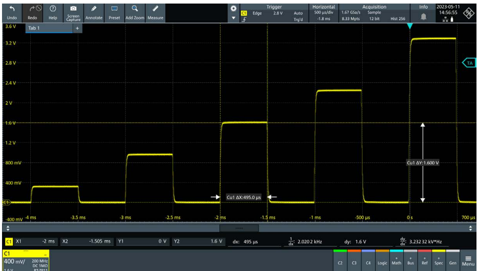
Screenshot: Messung eines Pulses mit der Cursorfunktion
