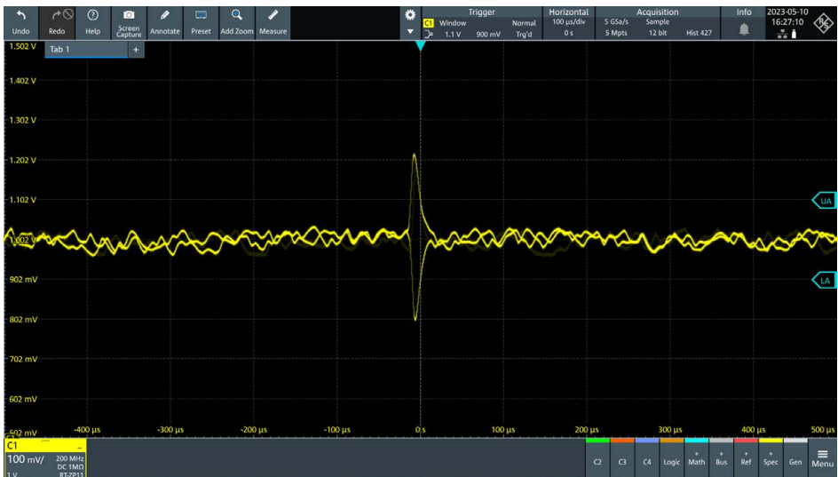
Screenshot: Triggerng mit dem Window-Trigger auf positive und negative Peaks einer Stromversorgungsleitung
