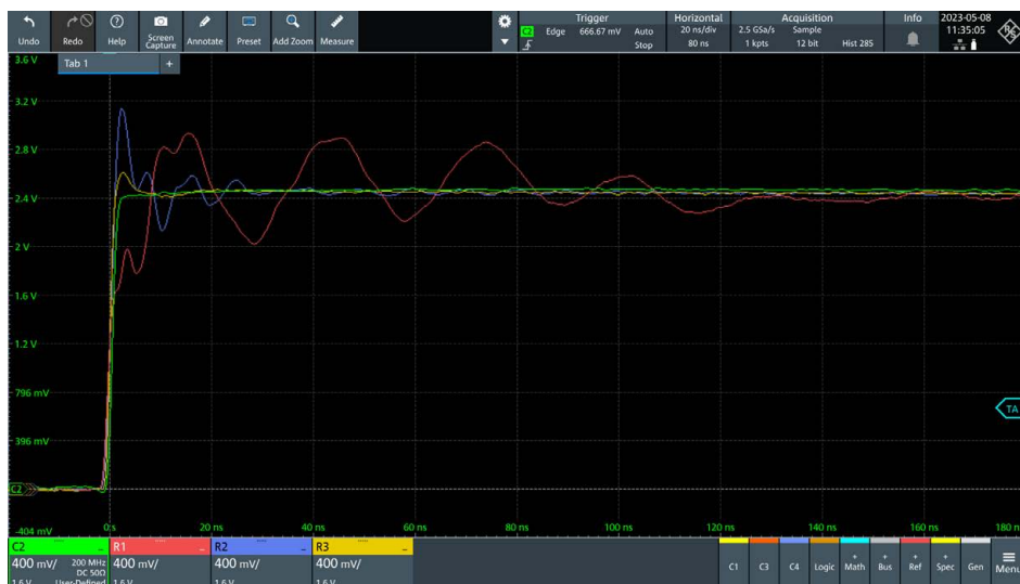
Screenshot: Die Auswirkung von verschiedenen Tastkopf-Masseanbindungen bei schnellen Flanken
