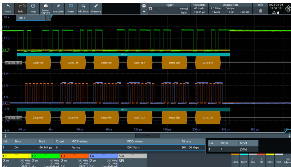
Screenshot: SPI-Schnittstellen-Dekodierung und Dekodertabelle
