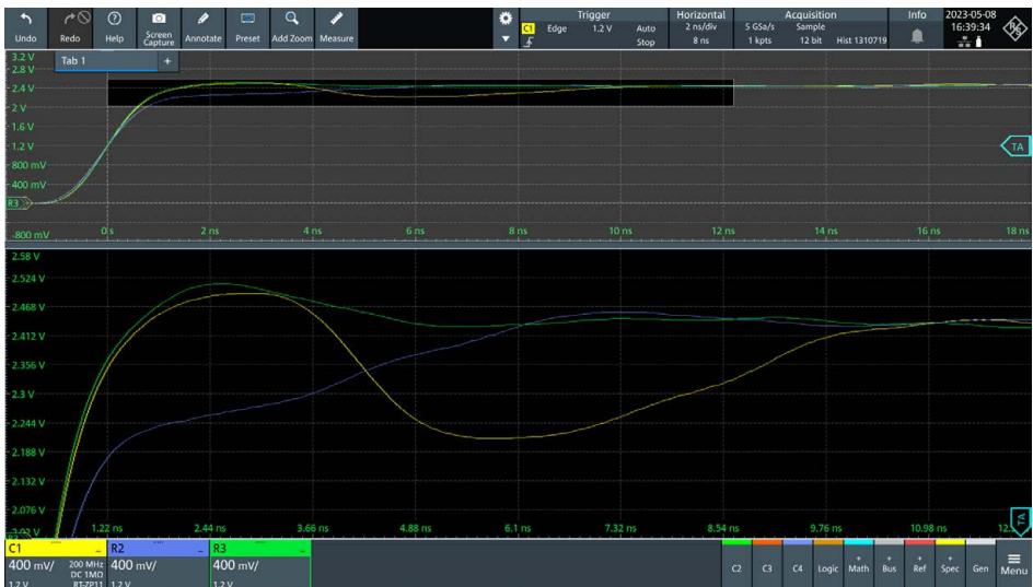
Screenshot: Signalbeeinflussung durch die Belastung mit einem Tastkopf
