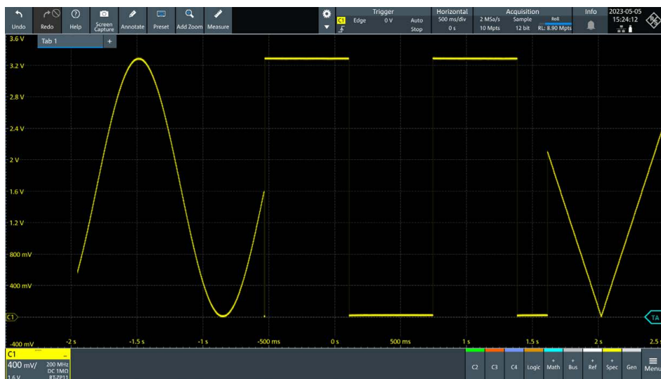
Screenshot: Roll-Mode mit wechselnden Signalverläufen durch Umschalten von Select 1 während der Messung
