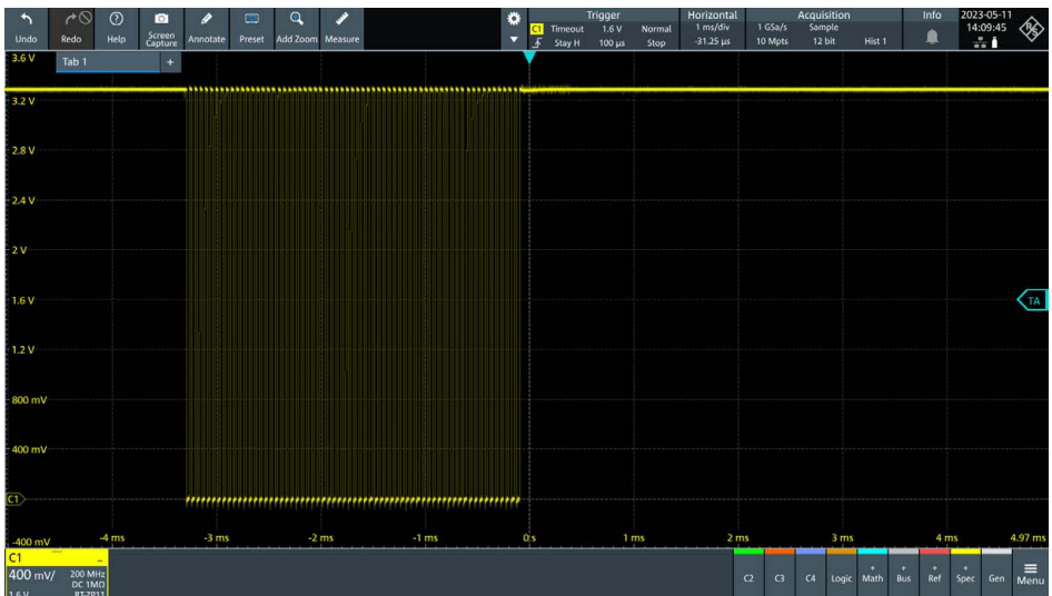
Screenshot: Triggerung mit dem Dropout- oder Timeout-Trigger auf das Ende einer Datenübertragung
