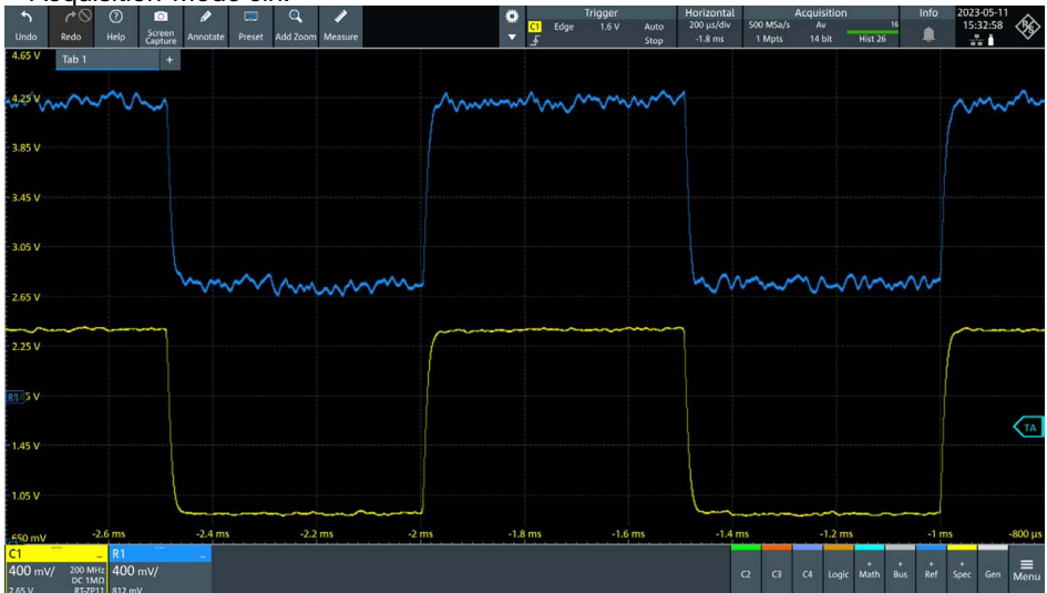
Screenshot: 1 kHz Rechteck mit starkem Rauschen (blaue Referenz: Normalmodus, gelbes Signal: Average-Modus)
