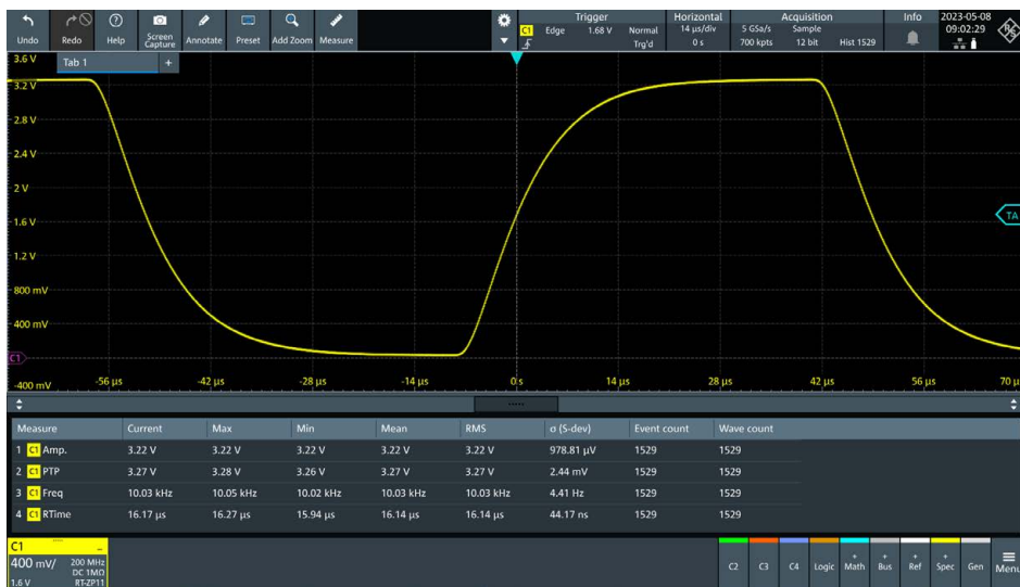
Screenshot: Automatische Messung verschiedener Signalparameter
