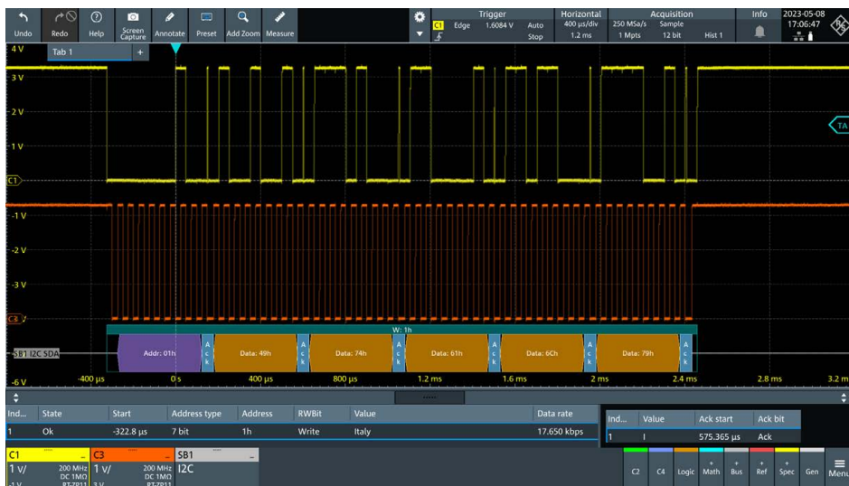
Screenshot: I 2 C-Schnittstellen-Dekodierung und Dekodertabelle
