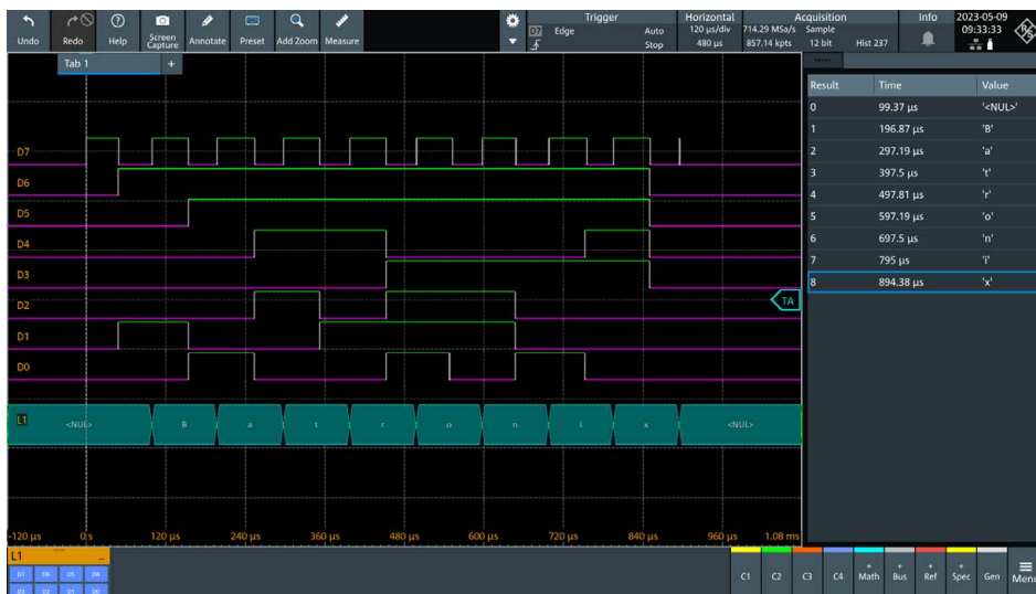
Screenshot: Parallelbus Schnittstellen-Dekodierung und Dekodertabelle
