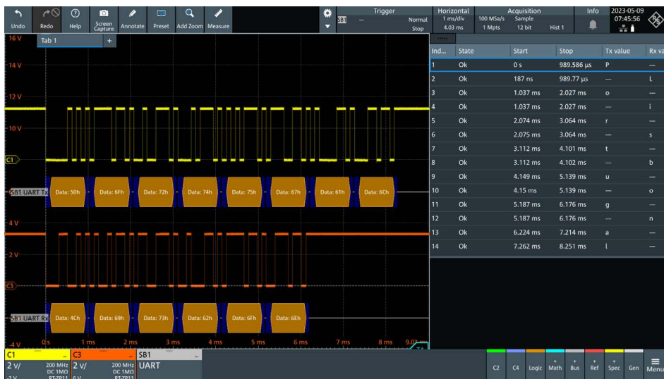
Screenshot: UART Schnittstellen-Dekodierung und Dekodertabelle
