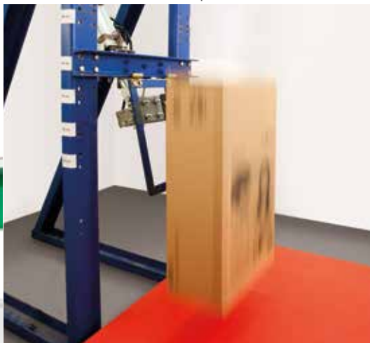
Falltest und Transportsimulation
