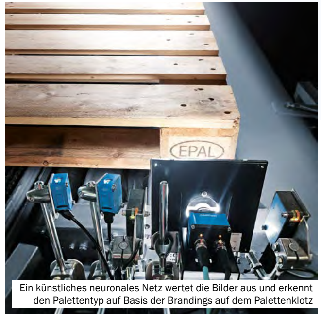
PACS kann an einer beliebigen Position entlang der Fördertechnik montiert werden und erfasst von zwei Seiten Bilder der Palettenklötze
