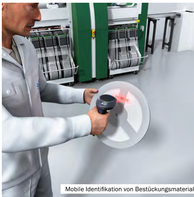
Rückverfolgbarkeit von Produkten und Prozessen durch sichere Code-Identifikation
