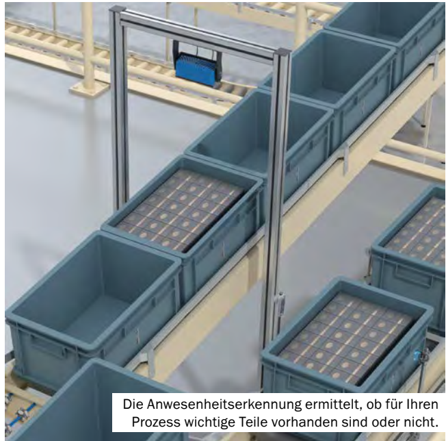
Vollständigkeitsprüfung prüft, ob alle für Ihren Prozess benötigten Teile vorhanden und in der richtigen Position sind
