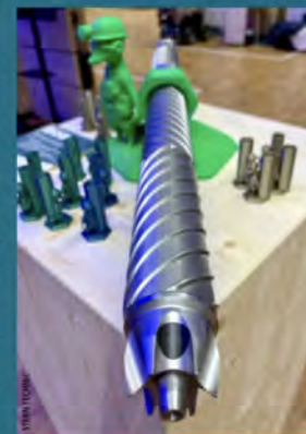
»BOB« (Boring roBot) ist ein kompakter und autonomer Bohrröhrer für präzise Horizontalbohrungen in lockeren Böden.
