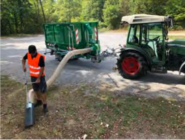
Handgeführter Saugschlauch mit Aufnahmelanze
