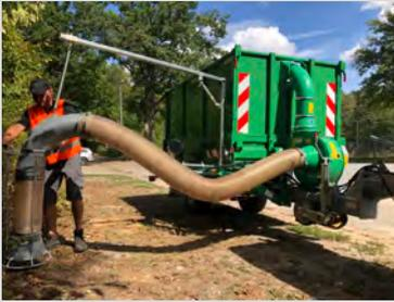
Handgeführter Saugschlauch mit Aufnahmelanze oder federentlastetes Saugrohr für eine leichte und arbeitsschutzgerechte Führung des Saugschlauches
