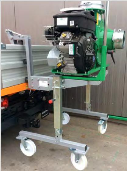
Verladegebläse S 400 über Silentblöcke auf einen Einhängerrahmen mit Klemmverschlüssen montiert.
