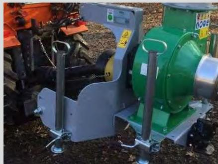
Verladegebläse T 400 mit Aufnahme für Kraftheber und Zapfwellenantrieb
