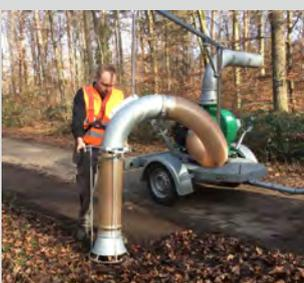
Handsaugschlauch mit Federentlastung
