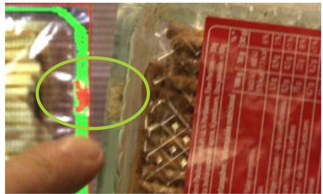
HyperScope®-Analyse im Vergleich zu abgelehnter Verpackung
