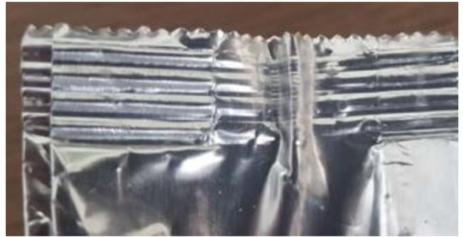
Beutel mit unerwünschten Falten, der vom **SealScope**® System aussortiert wird.
