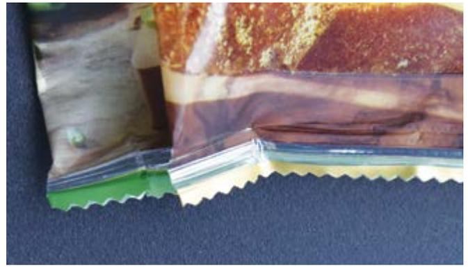
Abgelehntes Paket mit Falten in der Schweißnaht.
