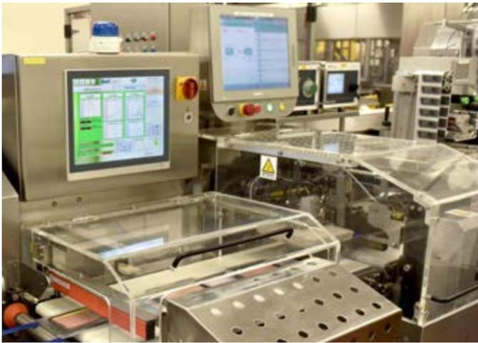
Sensoren an den Siegelbalken erkennen, ob Produkt-, Materialeinschlüsse oder Falten im Siegelnahtbereich vorliegen.
