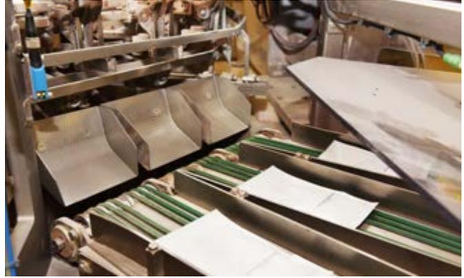
Defekte Pakete werden mit einem Schiebelukensystem vom Band abgeworfen
