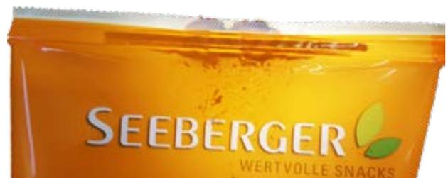
Typisches Beispiel von verunreinigter Siegelnaht durch Produkteinschluss
