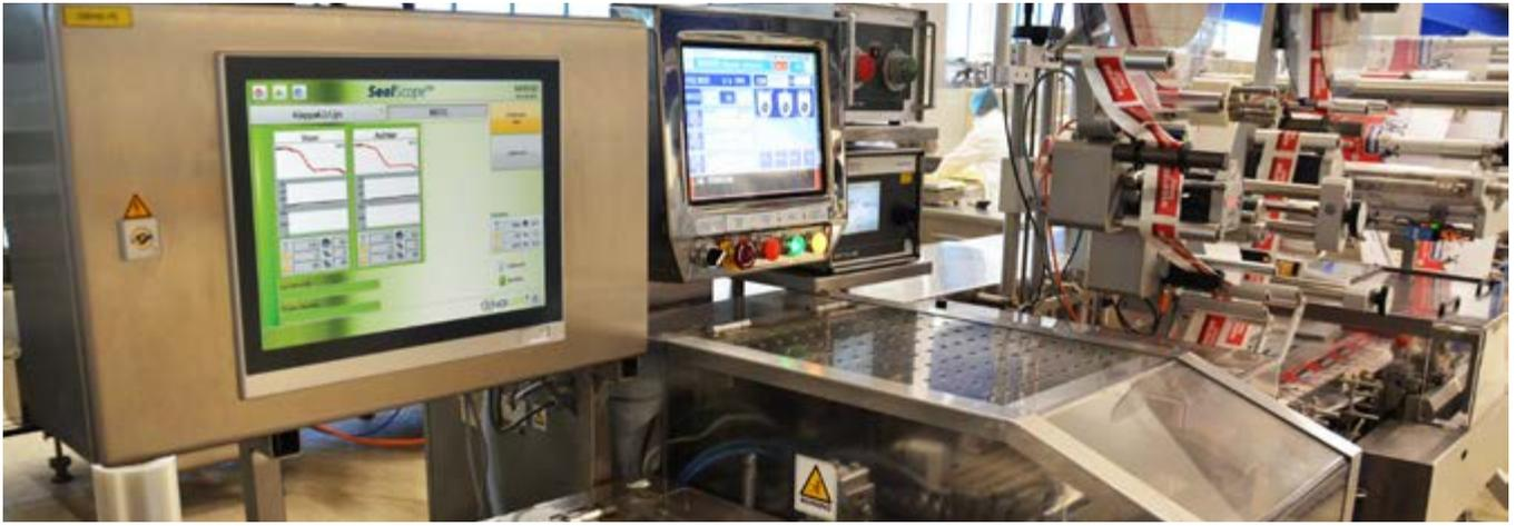
**SealScope®** Touchscreen-Überwachungspult in der Verpackungslinie
