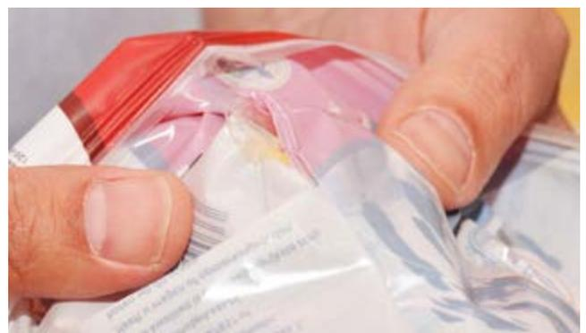
Käsestücke in der Siegelnaht werden in einer Verpackung zurückgeholt, die von **SealScope®** abgelehnt wurde
