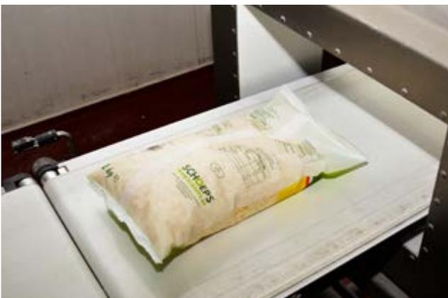
den. Aus guten Versiegelungen wird ein Referenzsignal erzeugt, und während der Produktion wird das Signal für jeden versiegelten Beutel mit dieser Referenz verglichen. Knicke/Falten oder Produkteinschlüsse verursachen ein anderes Signal als die Referenz. Wird eine fehlerhafte Versiegelung erkannt, meldet **SealScope**® den Fehler und gibt ein Signal an einen Auswerfer aus, um den schadhafte Beutel zu beseitigen.
