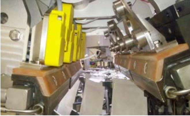
Sensoren an den Schweißbalken erkennen, ob sich Produkt oder Falten in der Schweißnaht befinden
