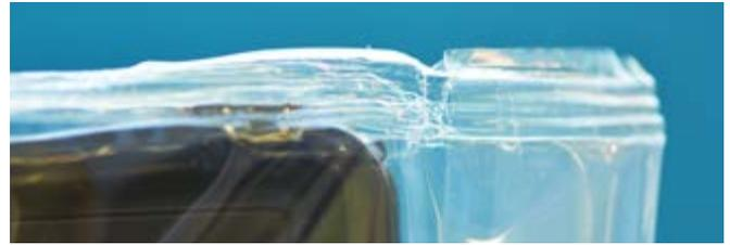
Fehlerhafte Verpackungen mit Falten (oben) und Kunststoffschale in der Siegelnaht (unten), die vom **SealScope**®-System aussortiert werden.
