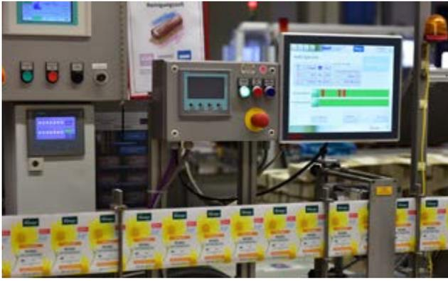
SealScope® Controller in Badesalz-Verpackungslinie integriert.
