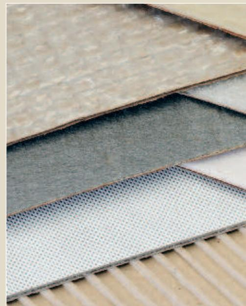
Flexipack Multimaterial, ausgerüstet mit PE-, PU-Schaum, Luftpolsterfolie, PP-Vlies und Goretexgewebe, entsprechend den Kundenanforderungen
