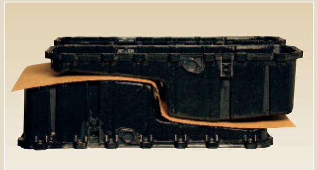
Die Flexibilität von Flatpad ermöglicht die effiziente Abstapelung empfindlichster Teile
