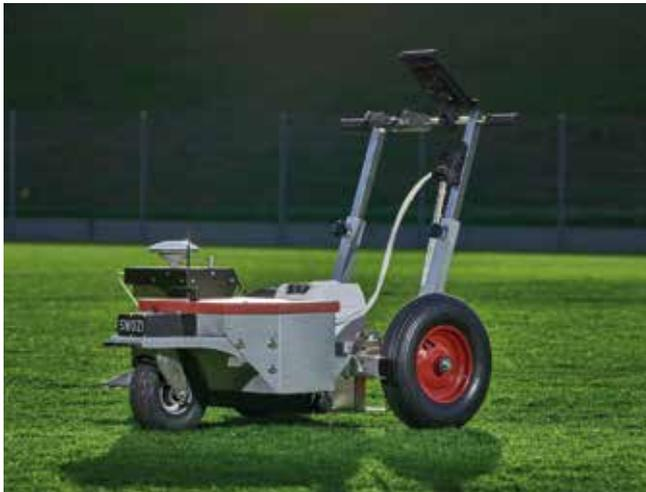
Der SWOZI-Wagen ist aus leichtem Aluminium gefertigt und hat eine Griffstange zum einfachen Schieben.
