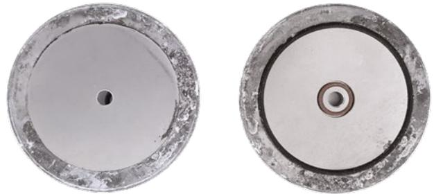
Bild 4: Aluminium Druckguss Prüfkörper mit der Legierung AlSi12 (Fe) ohne AntiCorr®-Schicht (nach 720 Stunden Salzsprühnebeltest gemäß DIN ISO 9227)
