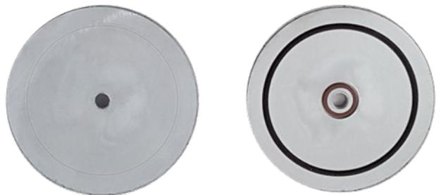
Bild 5: Aluminium Druckguss Prüfkörper mit der Legierung AlSi12 (Fe) und AntiCorr®-Schicht (nach 720 Stunden Salzsprühnebeltest gemäß DIN ISO 9227)
