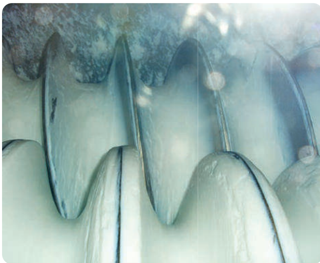
Produktbelag an Schneckenwendel
