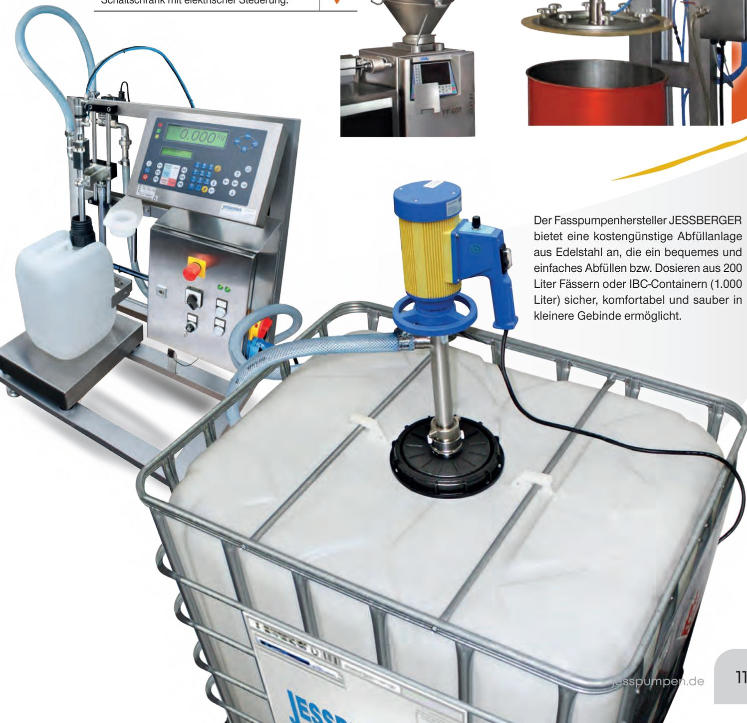
Der Fasspumpenhersteller JESSBERGER bietet eine kostengünstige Abfüllanlage aus Edelstahl an, die ein bequemes und einfaches Abfüllen bzw. Dosieren aus 200 Liter Fässern oder IBC-Containern (1.000 Liter) sicher, komfortabel und sauber in kleinere Gebinde ermöglicht.
