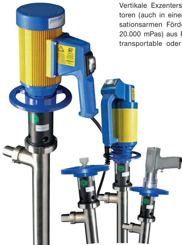
Vertikale Exzentrerschneckenpumpen mit Wechselstrom- oder Druckluftmotoren (auch in einer ATEX Version erhältlich) sind zum schonenden und pulsationsarmen Fördern von dünnflüssigen bis viskosen Flüssigkeiten (max. 20.000 mPas) aus Fässern und Behältern geeignet. Sie werden entweder als transportable oder stationäre Pumpen im kurzfristigen Betrieb eingesetzt.
