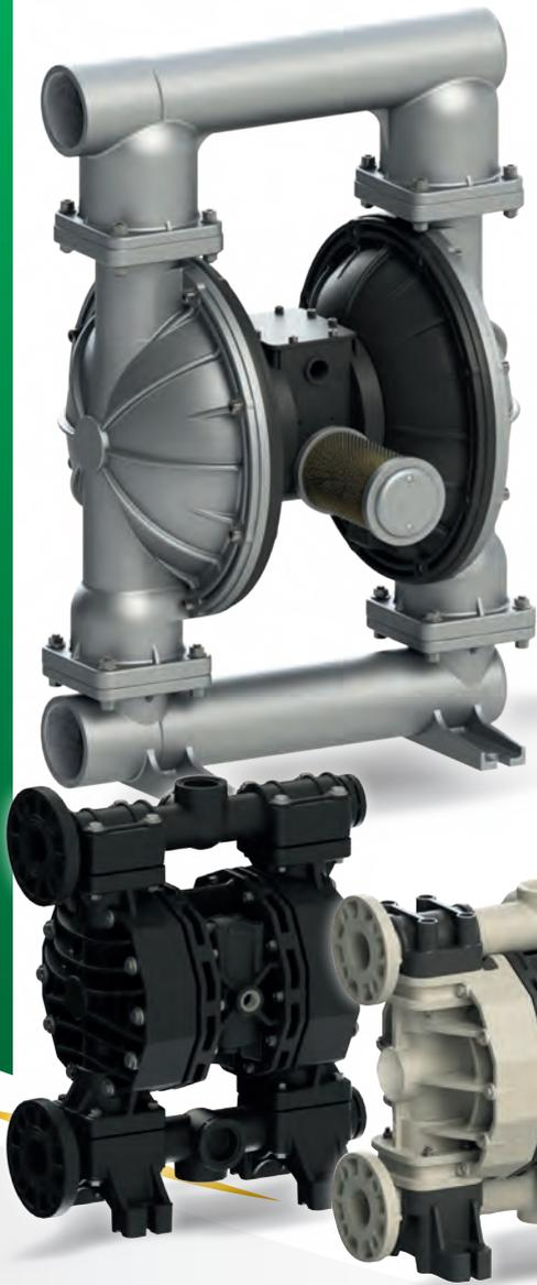
Druckluftbetriebene Membranpumpen sind für fast alle Einsatzzwecke geeignet. Sie sind selbstansaugend, können trockenlaufen und fördern aggressive, brennbare oder viskose Medien (max. 55.000 mPas, abhängig vom Pumpentyp), auch mit Feststoffanteilen sowie Medien mit Gasanteilen.
