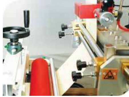
Tutkallanmış Malzemeyi Kesişim Noktasında Hizalayan Baskı Merdanesi The Press Roll is Align Glued Material in Intersection Point
