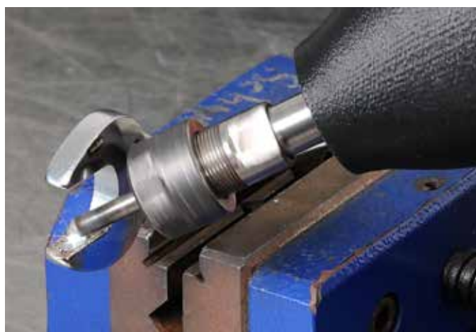
oben: Auftragung einer Schutzschicht an gefährdeter Fläche unten: Erzeugen einer Grifffläche zur besseren Kraftübertragung
