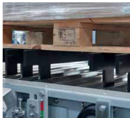
ELÉVATEUR DE PALETTE Dispositif de soulèvement de la palette
