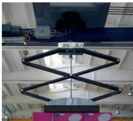
PRESSEUR Dispositif de stabilisation de la charge
