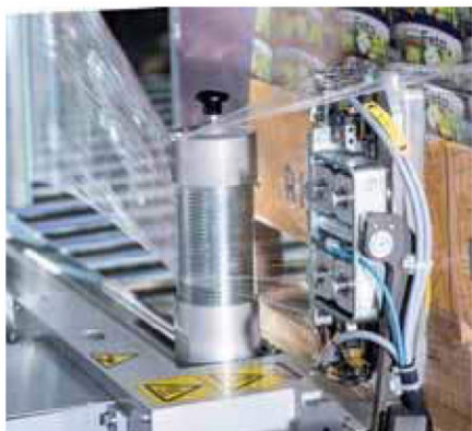
PINCE-FILM A RESSORT Système intégré de pince, coupe et soudure du film opérant sans contact avec le produit
